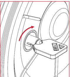
Tournez la clé de verrouillage à 90 degrés vers l'avant
