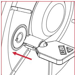
Insérer la clé de verrouillage
