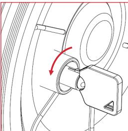
Tourner la clé de verrouillage à 90 degrés vers l'arrière
