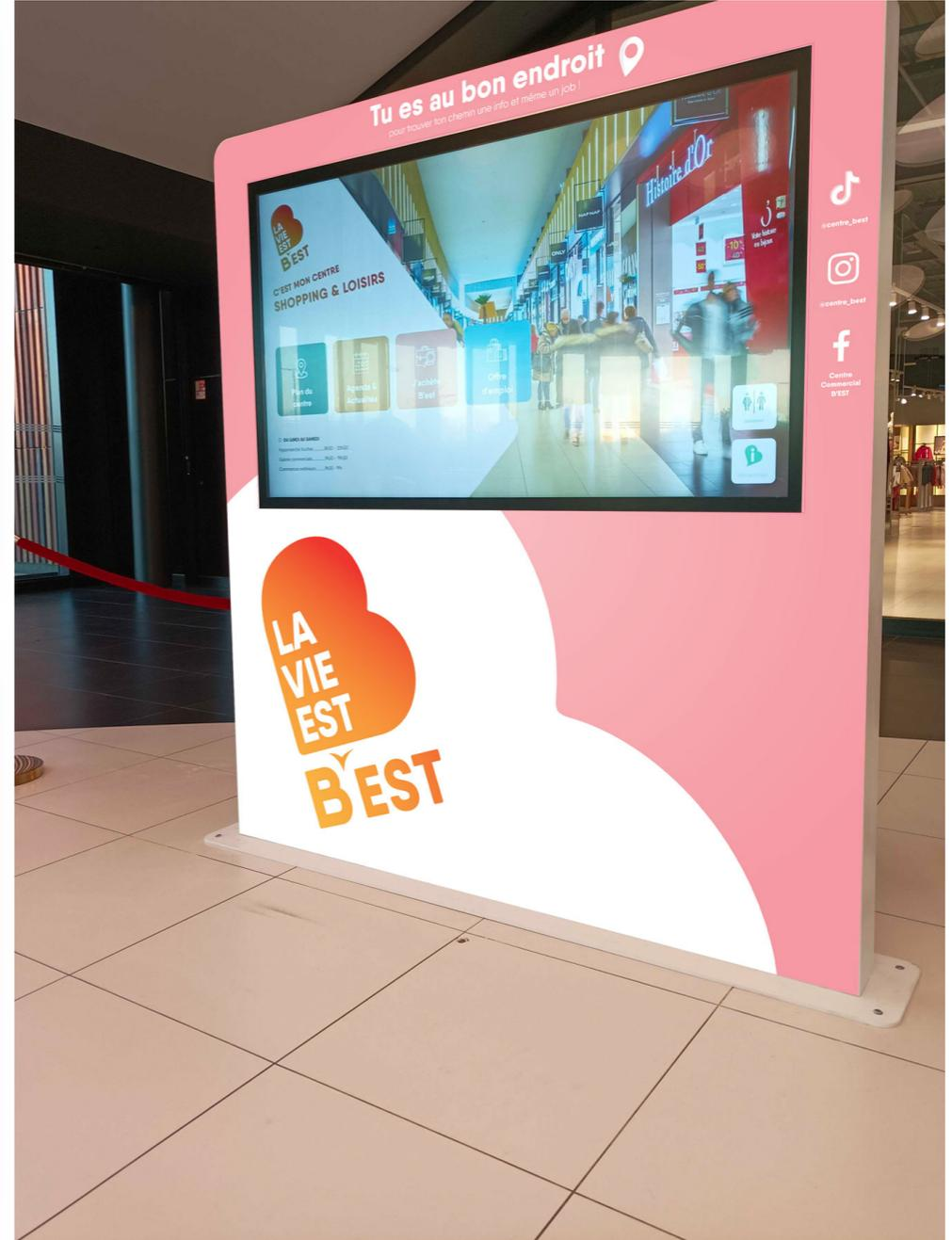
L'application a été livrée avec 3 **bornes tactiles GIANT 65 pouces**. Afin de se fondre parfaitement au sein de la galerie marchande, elle a été recouverte d'un **habillage aimanté** aux couleurs du centre commercial.
